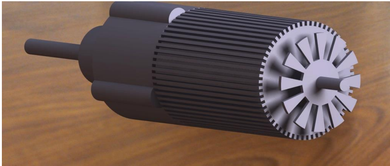
شکل ۲-۳ موتور حرکتی روبات و پره‌های انکودر آن
